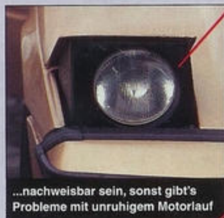
Die Inspektion der via Unterdruck gesteuerten Scheinwerfer sollte ...
