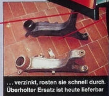
Schwachstelle Nummer eins: die Hinterachsschwinge. Nicht ...
