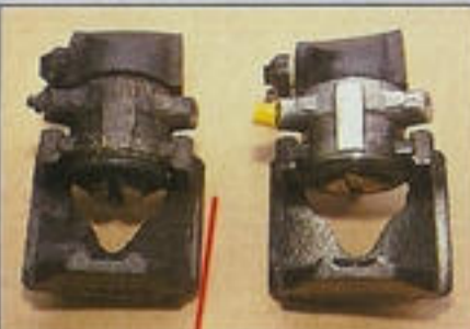
Handbremse inklusiv: Die hinteren Bremszangen sind reparabel
