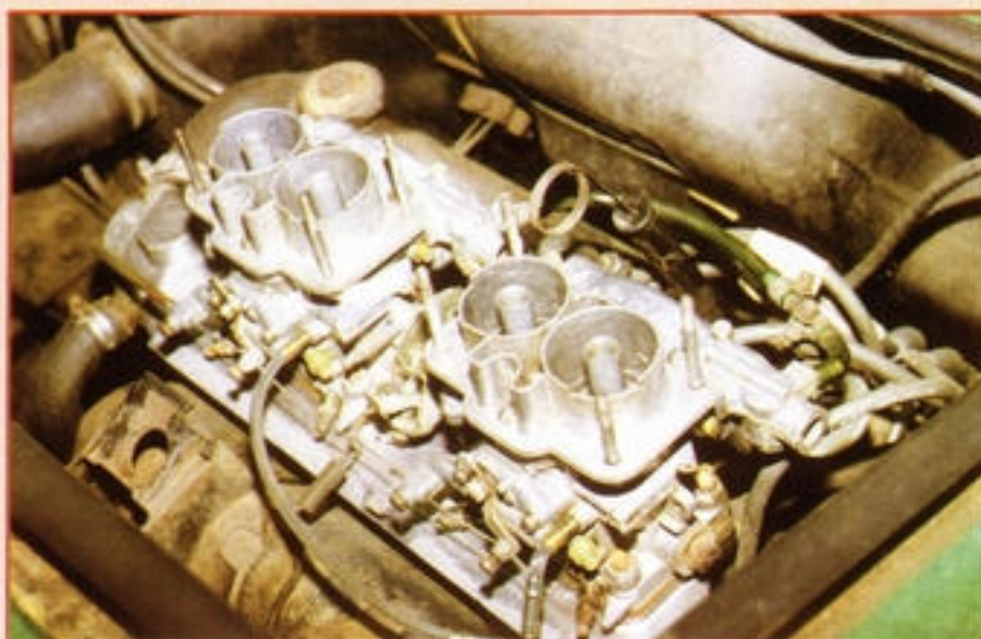
Bovenop de moeilijk toegankelijke motor zijn de twee dubbele Webers gemonteerd.
