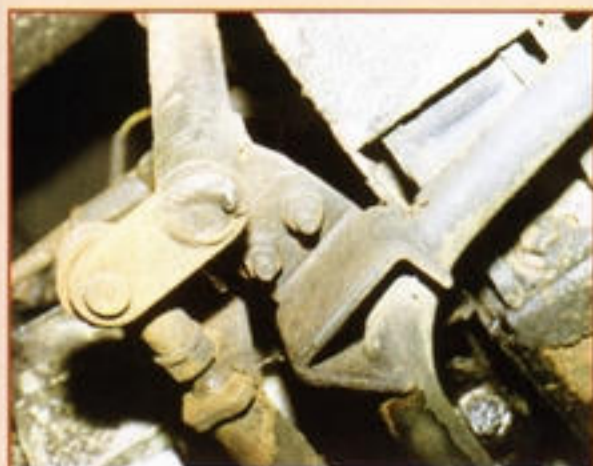
De gecompliceerde overbrenging van het schakelmechaniek vraagt om regelmatige controle en is breukegevoelig bij de ophanging aan de bodemplaat.
