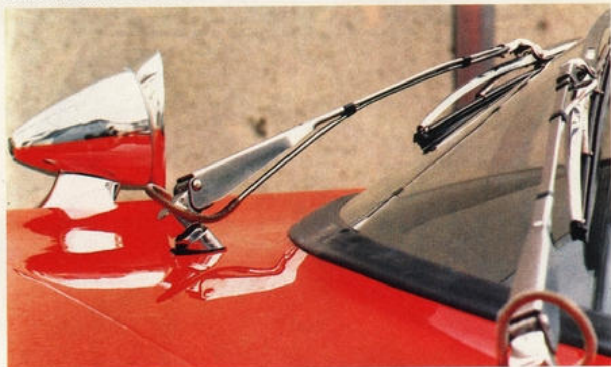
Originelle Lösung: Die Düsen der Waschanlage waren direkt am Scheibenwischer angebracht.
