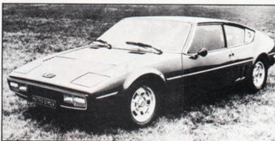
Erst auf den zweiten Blick erkennt man die Karosserie-modifikationen beim U8: Um den längs eingebauten V8-Motor unterzubringen, mußten Radstand und Heckpartie verlängert werden.
