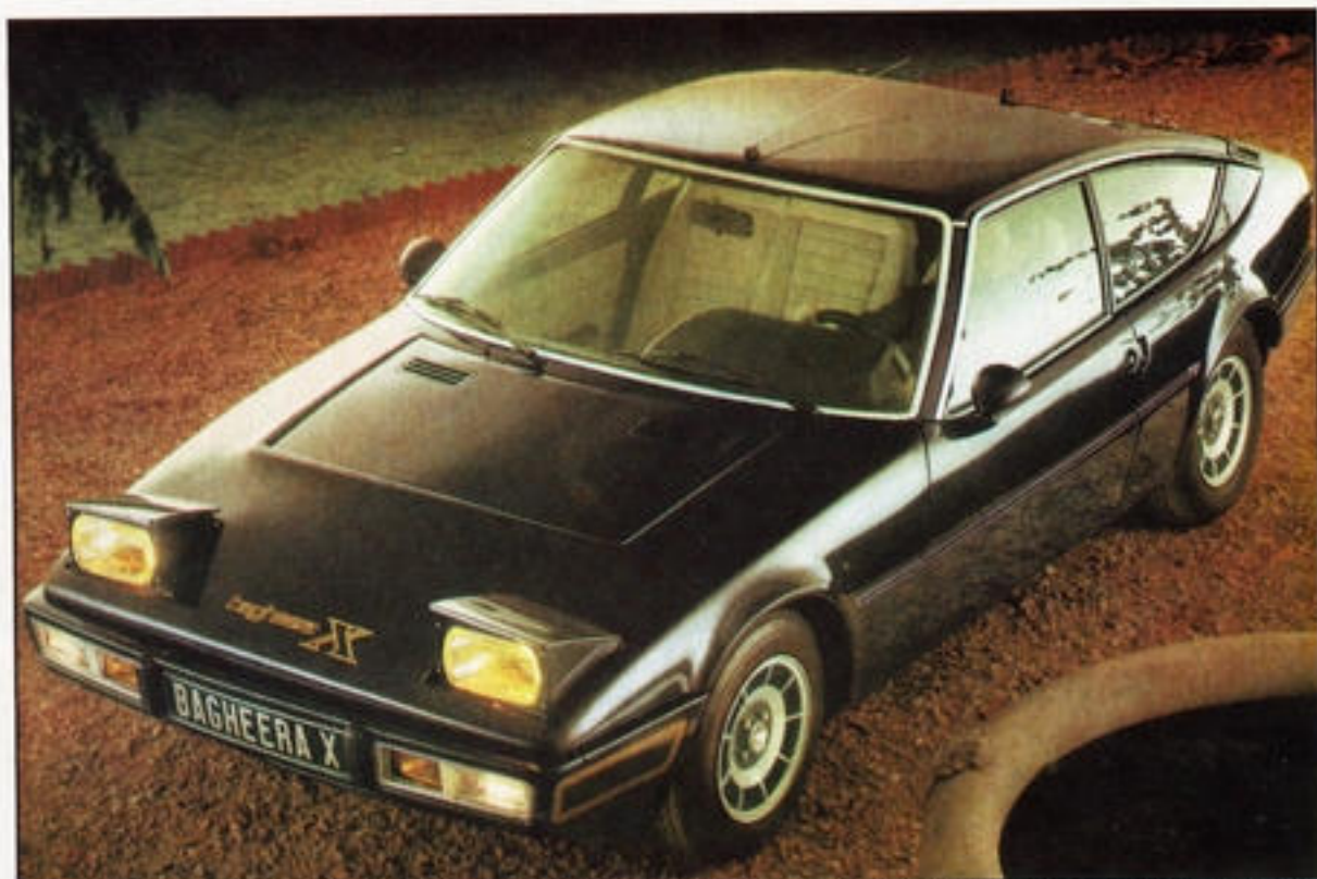
Das überarbeitete Mittelmotor-Coupé, hier ein Bagheera X mit dem 1,5-Liter-90-PS-Sportmotor, zeichnete sich durch den sehr niedrigen Luftwiderstands-Beiwert von 0,32 aus.
