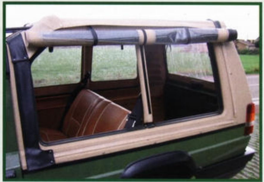
Découvrable! In België werd een nieuwe kap gemaakt. In de zomer kan het aan alle kanten worden open geritst en zelfs helemaal verwijderd.
