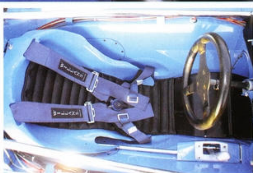
Op deze foto is goed te zien dat de coureur ingeklemd zat tussen beide benzinetanks
