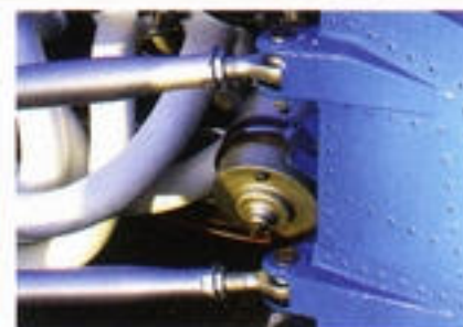
De achterwielophanging zit enerzijds aan de achterzijde van de monocoque vast, aan de achterzijde is deze aan de motor gemonteerd
