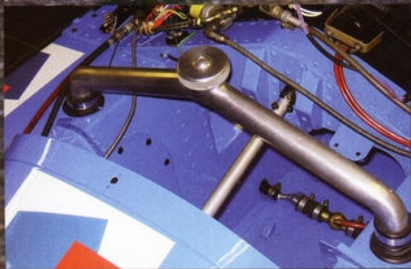
De verbindingshuis tussen beide benzinetanks met de daarop geplaatste benzinevuldop moest worden nagemaakt
